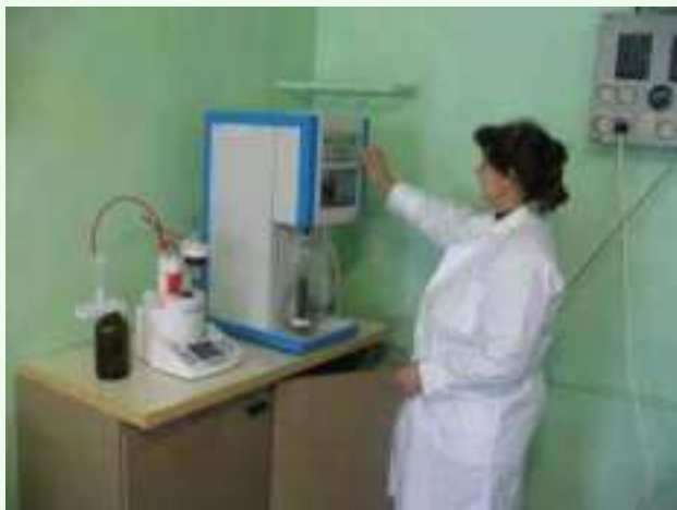
Определение азота по Кьельдалю – стандартный показатель при определении качества корма
